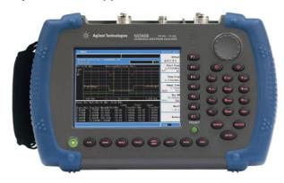
Специально разработанный для использования в полевых условиях эксплуатации, анализатор спектра N9340B обладает практичностью и высокими рабочими характеристиками, необходимыми для решения задач спектрального мониторинга, установки, обслуживания и ремонта оборудования на месте его установки. В качестве опций в анализатор могут быть установлены следящий генератор и предусилитель.
